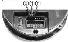
дополнительный 7-контактный разъем МК опциональные цепи подключения
