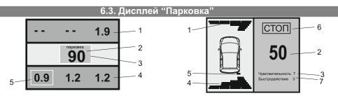
При включении парктроника МК переключается в "Дисплей Парковка" (при подключенном парковочном радаре Multitronics - опция).
