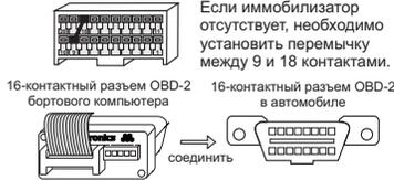
Если в машине присутствует диагностический разъем Евро-2, подключение К-линии производить по следующей схеме
